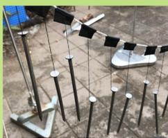
Fe釘をマシン糸で実験装置にぶら下げ, 風通しの良い場所に設置し, 人工海水をかけた。
